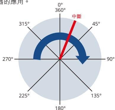
角度計時器的基本操作來自兩個輸入信號，由角度計時器信號寄存器(ATxSIG)所指定的輸入信號來源，以及角度計時器時鐘寄存器(ATxCLK)所選擇的輸入時鐘。根據這些信號，創建三個輸出：
