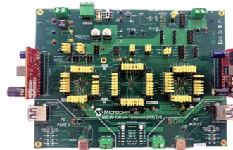
圖 (二A) 功能強大的 SAMD20 MCU 及 UPD350 收發器參考設計晶片開發板
