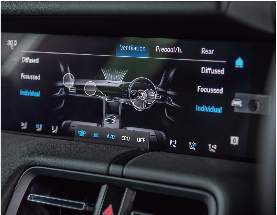
智慧座艙中控一體化螢幕整合導航、空調與車輛控制介面，體現數位化座艙設計趨勢。
