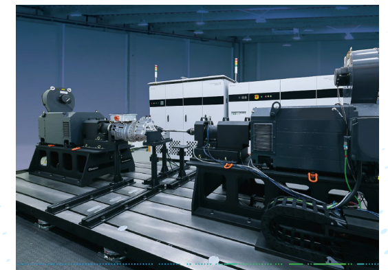
致茂電子電驅動總成測試平台，可模擬電機、逆變器與減速機等動力域控制器的協同運作，協助驗證扭力輸出、能量管理與長期可靠度等關鍵參數，是車廠評估整車「電控能力」的重要基礎。(圖片提供：致茂電子)
