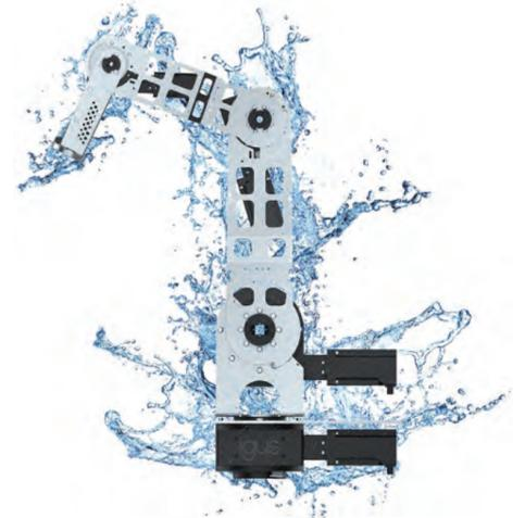
由於免潤滑工程塑膠和防腐蝕不鏽鋼的組合，新型roboLink具有IP44防護等級。
