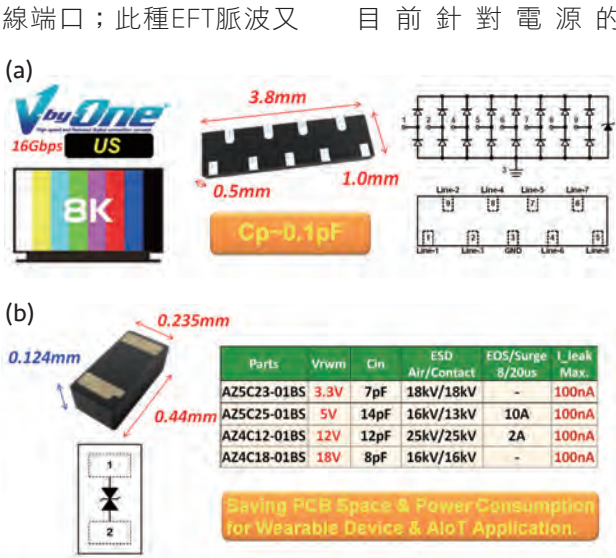
▲(a)晶焱八通道TVS寄生容值僅為0.1pF，可應用於V-by-One Ultra Speed介面 (b)晶焱科技01005尺寸TVS產品系列。
