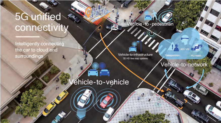
▲車對車、車對設施的V2X通訊技術，可讓自動駕駛車取得超越傳統駕車條件更完整、即時的用路條件資訊。
