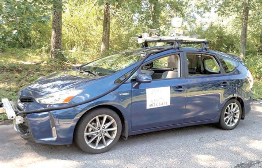
▲ CSAIL MapLite專案選擇與Toyota公司合作，在車輛上依照研究團隊需求安裝多個雷達系統與IMU感測器，具備探測100英尺外道路狀況的能力。
