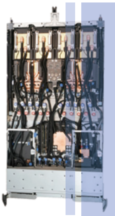
鴻海在 NVIDIA GTC 大會上，展示與 NVIDIA 合作最新 GB300 NVL72 伺服器機櫃純液冷版本，其每層 Compute Tray 將配置 9~12 個水冷板。 鴻海
