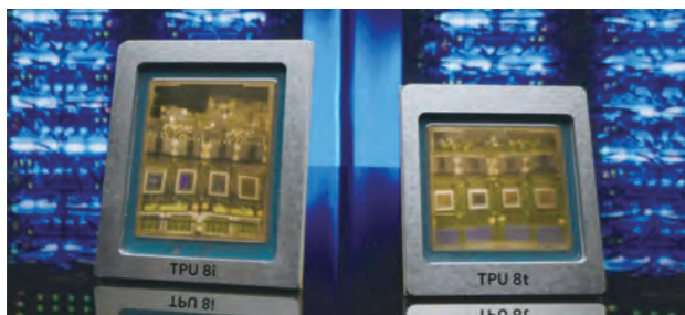
Google 第 8 代 TPU，首度採用雙晶片架構。Google Cloud
