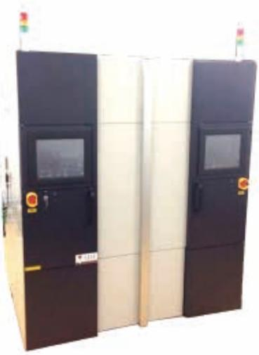
▲DISCO推出雙加工點隱形雷射切割機。
