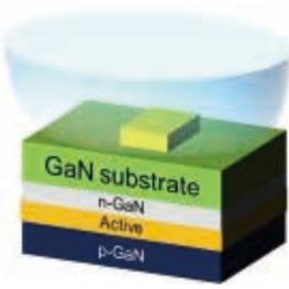
▲螢光膜適用於垂直LED架構，直接覆蓋發光區域，不會有側面漏光問題。適合路燈、車燈等高功率LED。以現階段技術來說已經不受限於垂直LED架構，水平式LED架構也適用。
