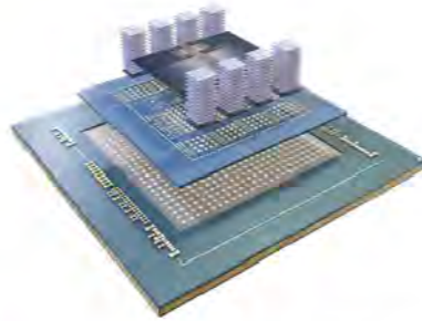
先進封裝技術將 GPU 與 HBM 整合到單一 AI 晶片封裝上，其中介層與 IC 基板可促進晶片之間的通訊與數據傳輸。
