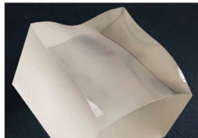
此玻璃工件的自由曲面是使用 Röders 5 軸高速加工機 RXP501DS 搭配鑽石工具進行拋光 (照片提供：Shape Fab)
