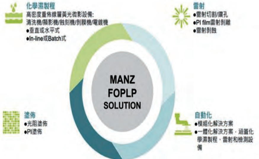
▲整合集團內的核心技術為FOPLP封裝技術提供濕製程、自動化、精密塗佈及雷射等製程設備。
