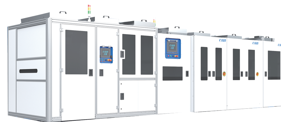
志聖ABF RCC真空壓膜解決方案，製程可選配熱壓段。
